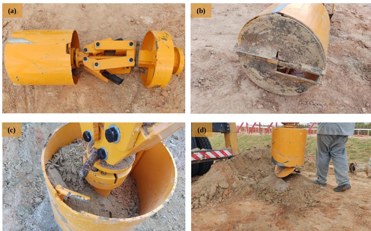
Figura 2. Vistas do dispositivo de limpeza desenvolvido: (a) vista lateral do equipamento; (b) vista inferior com abertura na base para descarte do material; (c) compartimento interno destinado ao armazenamento dos resíduos removidos do fundo da escavação; (d) descarte do material armazenado após a limpeza.
