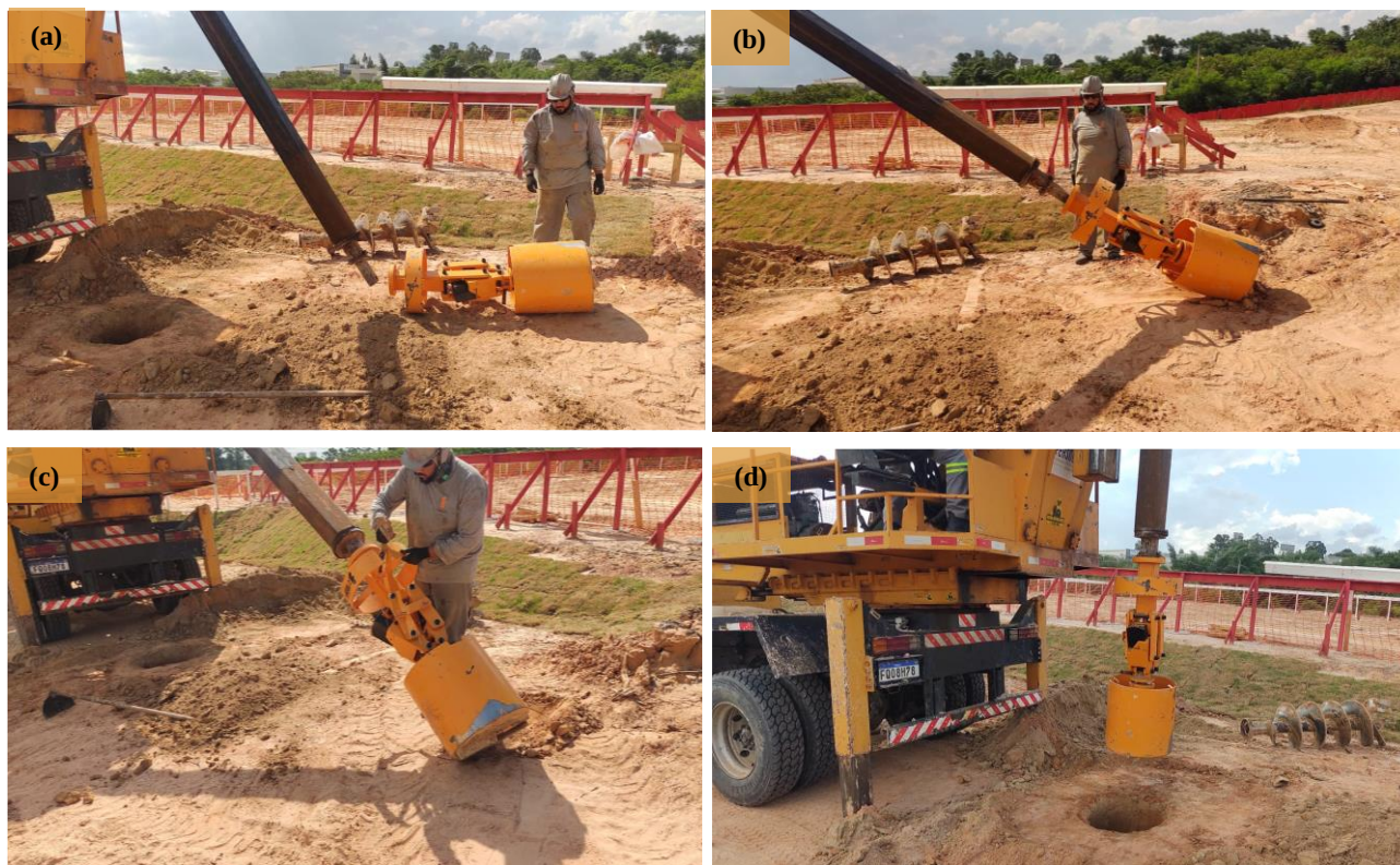
Figura 3. Sistema de acoplamento do dispositivo de limpeza: (a) visão geral do dispositivo e da haste à qual será conectado; (b) detalhe do sistema de engate hidráulico utilizado para o acoplamento; (c) fixação final do dispositivo à haste; e (d) dispositivo pronto e liberado para operação.
